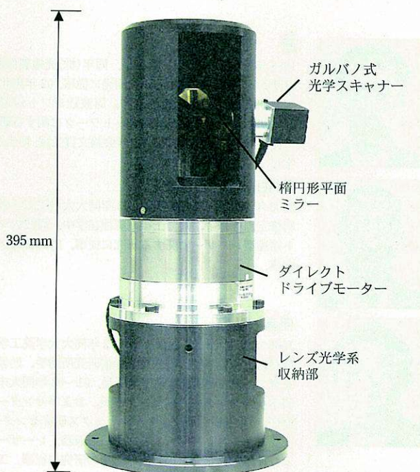
図9 高精度レーザー scanner 部。
